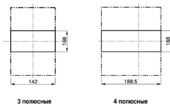
Рисунок Б.12 – Габаритные и монтажные размеры выводов для подключения сзади
