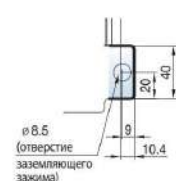
Рисунок В.38 – Габаритные размеры выключателя с вертикальными выводами
