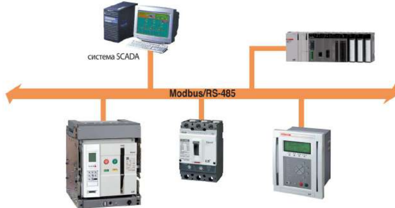
Рисунок 52 – Передача данных по сети Modbus Profibus-DP
