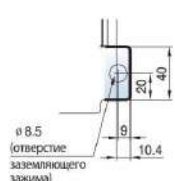
Рисунок В.38 – Габаритные размеры выключателя с вертикальными выводами
