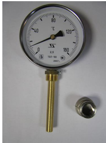
Рис. 7.2 Термометр стрелочный типа ТБП-63
