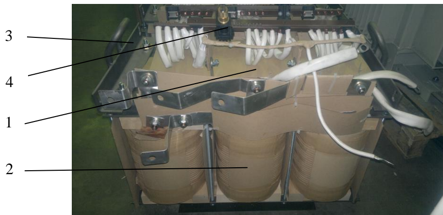
Рис. 2.1 Активная часть в сборе. 1 – магнитопровод; 2 – блок обмоток ВН – НН; 3 – крепление; 4 – переключатель;
